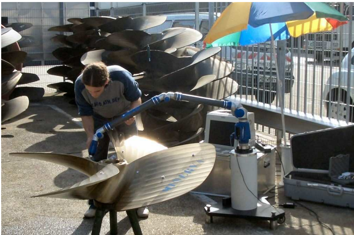
Abb. 1: Mobiler Einsatz eines 3D-Gelenkmessarms des Herstellers Faro im Rahmen einer technischen Messung, aus [DÜRMUTH 2005].
