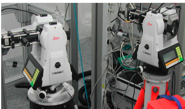
Abb. 3: i3mainz-Digitalkamera-Theodolite für automatisierte und kinematische Kollimations- und Autokollimationsbeobachtungen. Mit freundlicher Genehmigung der Tesat-Spacecom GmbH & Co. KG
