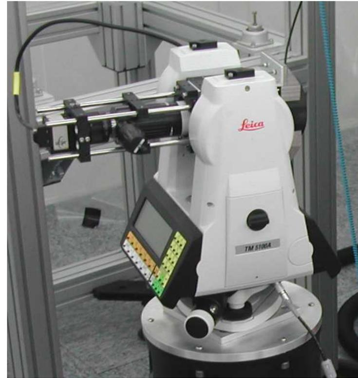
i3mainz-Digitalkameratheodolit auf Basis des Autokollimationstheodolits Leica TM5100A
